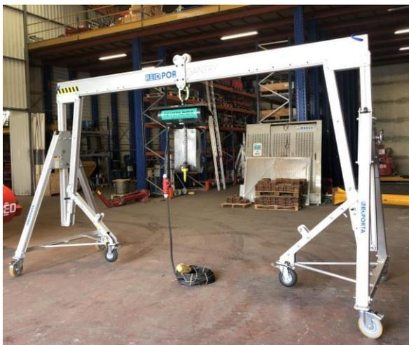
Portique roulant 5 000kg/4,5 m avec palan électrique en position de montage (roues jockey déployées)
