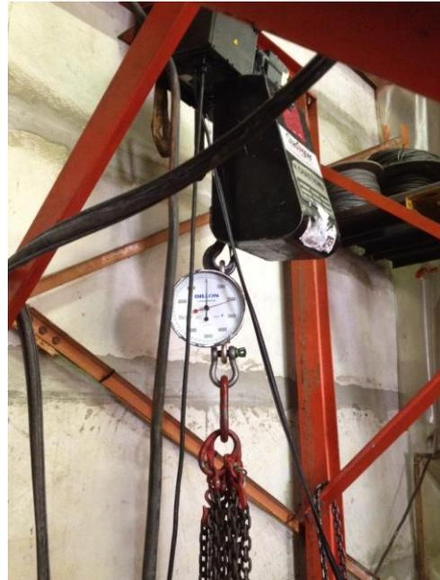
Réglage d'un limiteur de charge sur un palan électrique à chaîne
