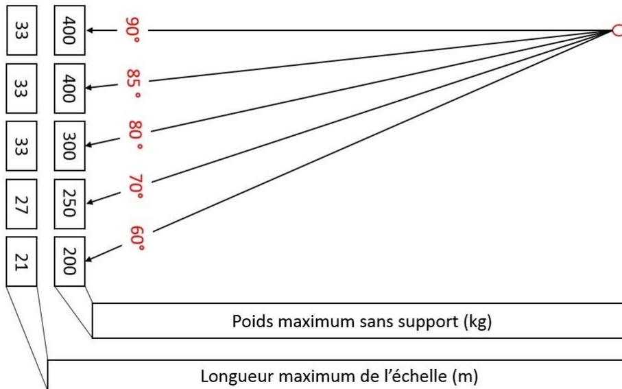
Supports obligatoires en dessous de 60°. Ne pas employer avec un vent  $\geq$  55 km/h. La pièce de tête doit être appuyée à l'immeuble.
