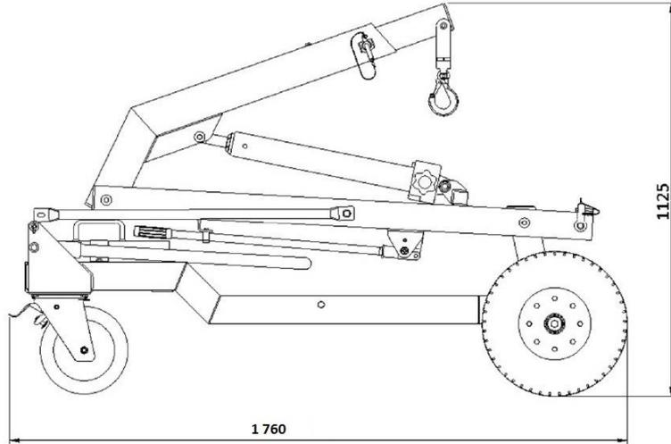
**Dimensions pour le transport (L x l x H) : 1 760 mm x 795 mm x 1 125 mm**
