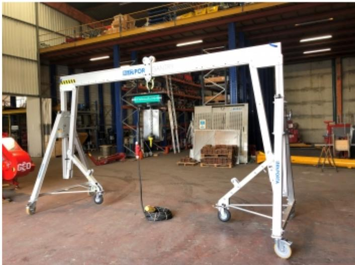
Portique roulant 5 000kg/4,5 m avec palan électrique en position de montage (roues jockey déployées)
