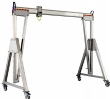
Portique en aluminium roulant 3000 kg/4,5 m. Ce portique de levage mobile monopoutre est réglable en hauteur et en portée. Léger et de faible encombrement, il se transporte et se met en œuvre facilement sans outillage particulier. Portique déplaçable en charge, il peut être utilisé en intérieur ou en extérieur pour des travaux de pose, dépose ou positionnement de charges.
