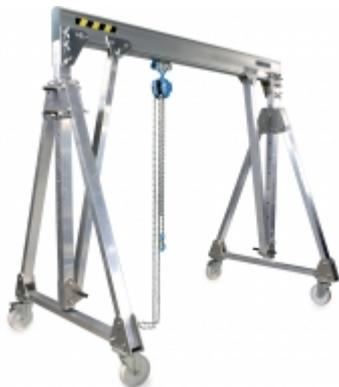
Portique en aluminium roulant 1600 kg/4 m. Ce portique de levage mobile monopoutre est réglable en hauteur et en portée. Léger et de faible encombrement, il se transporte et se met en œuvre facilement sans outillage particulier. Portique déplaçable en charge, il peut être utilisé en intérieur ou en extérieur pour des travaux de pose, dépose ou positionnement de charges.
