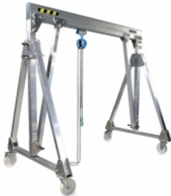
Portique en aluminium roulant 1600 kg/3 m. Ce portique de levage mobile monopoutre est réglable en hauteur et en portée. Léger et de faible encombrement, il se transporte et se met en œuvre facilement sans outillage particulier. Portique déplaçable en charge, il peut être utilisé en intérieur ou en extérieur pour des travaux de pose, dépose ou positionnement de charges.
