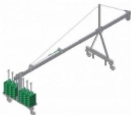
Portique avec déport 2 m/800 kg. Poutre de suspension entièrement démontable et réglable une fois installé sur chantier. Ce portique roulant avec déport est destiné uniquement à suspendre en partie haute des bâtiments du matériel spécifique pour desservir les niveaux inférieurs.
