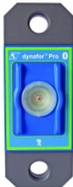
Peson électronique 1 000 kg. Ce dynamomètre électronique est une protection contre les surcharges. Il peut être utilisé avec plusieurs unités de mesures (kN / daN / lbs / t / ton (US) / kg), il permet de mesurer le poids ou une tension. Utilisé pour des mesures de tension de câble, de traction ou de pesée de charge suspendue.
