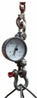
Peson à aiguilles 5 000 kg. Ce dynamomètre mécanique est une protection contre les surcharges. Il peut être utilisé comme une tare : il peut annuler les valeurs de charge présélectionnées jusqu'à 20 % de la capacité de l'instrument. Le peson à aiguilles permet aussi de mesurer le poids ou la tension. Il est utilisé pour des mesures de tension de câble, de traction ou de pesée de charge suspendue.
