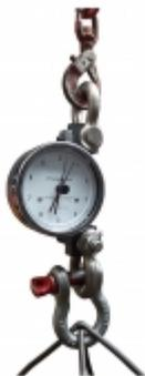
Peson à aiguilles 2 000 kg. Ce dynamomètre mécanique est une protection contre les surcharges. Il peut être utilisé comme une tare : il peut annuler les valeurs de charge présélectionnées jusqu'à 20 % de la capacité de l'instrument. Le peson à aiguilles permet aussi de mesurer le poids ou la tension. Il est utilisé pour des mesures de tension de câble, de traction ou de pesée de charge suspendue.
