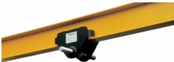
Chariot manuel de direction 5000 kg. Ce matériel permet le positionnement exact ou le déplacement aisé de charges importantes avec un palan à chaîne (électrique, manuel ou pneumatique). Il peut être monté sur tous types de profilés (IPN, IPE, HEA, HEB).
