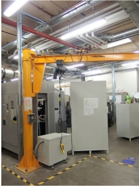
Installation sur portique avec un palan électrique
