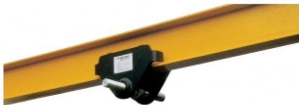
Chariot manuel de direction 500 kg. Ce matériel permet le positionnement exact ou le déplacement aisé de charges importantes avec un palan à chaîne (électrique, manuel ou pneumatique). Il peut être monté sur tous types de profilés (IPN, IPE, HEA, HEB).
