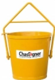
Benne basculante en acier 100 l. Ce matériel peut être utilisé sur chantiers pour la réception, le stockage et la manutention de béton, mortier, terre, gravats ou autres matériaux.
