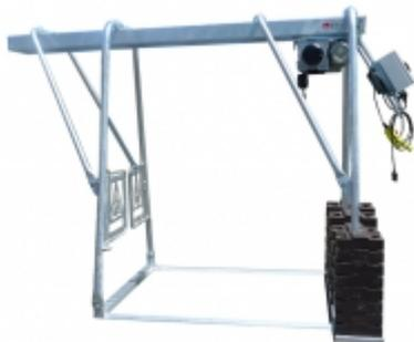
Treuil électrique sur chevalet 300 kg utile pour des travaux de grandes hauteurs depuis une terrasse ou en étage. Démontable en 4 éléments pour faciliter le transport, sa conception avec garde-corps intégré permet le levage de charges dans les meilleures conditions de sécurité grâce à un déport d'un mètre par rapport aux pieds avant. Sa mise en œuvre est simple et rapide. Le chevalet peut être ancré au sol ou lesté à l'aide de contrepoids placés dans des bacs ou un porte-lest prévus à cet effet.
