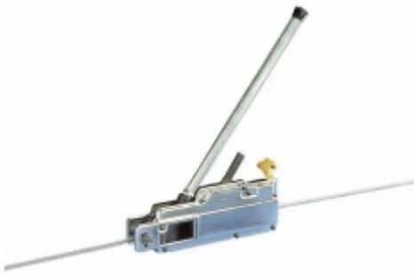
Treuil manuel à câble passant 800 kg. Le système dit « à câble passant » est une technologie permettant d'avoir des hauteurs de levée importantes pour un poids réduit de l'appareil. Ce matériel n'a pas de limitation par rapport à la longueur du câble de levage. Ce treuil manuel permet de lever, tirer et positionner des charges sur de grandes longueurs tout en gardant sa couple maximum. Il se manœuvre à l'aide d'un simple levier.
