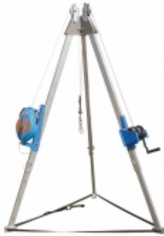
Trépied pour le levage de personne. Ce trépied est équipé d'un treuil manuel et d'un dispositif antichute pour le levage d'une personne ou le maintien d'une charge de 1 000 kg en position. Ce matériel possède une hauteur réglable est 6 positions et est utilisé pour un levage en réseaux souterrains.
