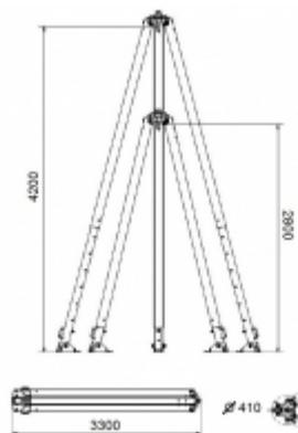
Trépieds 2 000 kg. Ce trépied de levage télescopique en aluminium est peu encombrant. Particulièrement utilisé pour effectuer des levages de charges en voirie ou en réseaux souterrains, ce trépied de chantier permet de disposer d'un point d'accroche supérieur. Le réglage de manière indépendante des pieds articulés facilite l'installation.
