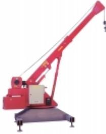
Grue Puisor 1000 kg disposant d'une grande hauteur de travail. Cette grue de levage dédiée aux opérations de puisatier de plus grande envergure. Entièrement électrique (levage et rotation), elle permet de supprimer toutes les interventions manuelles lors des déplacements de charges grâce à sa rotation à 360°.
