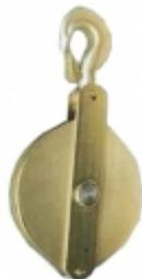
Poulie avec crochet de suspension destinée à toutes installations temporaires de levage ou de traction/halage disposant d'une charge utile de 6 000 kg. En plus d'une installation de mouflage, cette poulie de levage peut être utilisée en déviation de câble. Son système à chape ouvrante permet de faciliter sa mise en place et le passage du câble dans celle-ci. Le montage, le démontage ou la modification de configuration d'installation se font très rapidement.
