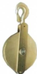
Poulie avec crochet de suspension destinée à toutes installations temporaires de levage ou de traction/halage disposant d'une charge utile de 22 000 kg. En plus d'une installation de mouflage, cette poulie de levage peut être utilisée en déviation de câble. Son système à chape ouvrante permet de faciliter sa mise en place et le passage du câble dans celle-ci. Le montage, le démontage ou la modification de configuration d'installation se font très rapidement.
