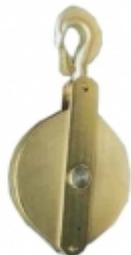
Poulie avec crochet de suspension destinée à toutes installations temporaires de levage ou de traction/halage disposant d'une charge utile de 1 250 kg. En plus d'une installation de mouflage, cette poulie de levage peut être utilisée en déviation de câble. Son système à chape ouvrante permet de faciliter sa mise en place et le passage du câble dans celle-ci. Le montage, le démontage ou la modification de configuration d'installation se font très rapidement.
