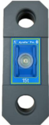
Peson électronique 15 000 kg. Ce dynamomètre électronique est une protection contre les surcharges. Il peut être utilisé avec plusieurs unités de mesures (kN / daN / lbs / t / ton (US) / kg). Il permet de mesurer un poids ou une tension. Utilisé pour la mesure de tension de câble, de traction ou pesée de charge suspendue.
