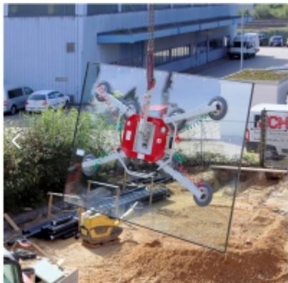
Qu'il s'agisse de bois, de verre ou de tôle, le palonnier est une solution de levage par le vide d'air. Ce matériel assure la prise, le positionnement et le déplacement en sécurité de toutes les pièces volumineuses jusqu'à 600 kg grâce aux ventouses (pression atmosphérique) sur des terrains exigus.
