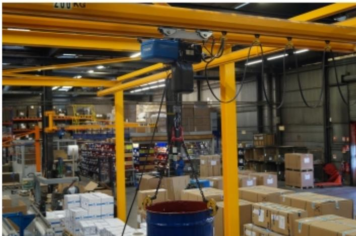
Installation sur pont roulant
