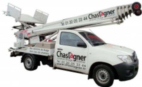
Monte-meubles sur véhicule Shorty 29 m avec opérateur. Très utilisé lors des opérations de levage ou d'évacuation de tous types de matériaux depuis l'extérieur d'un bâtiment, ce monte-meubles autoporté est le plus compact des monte-meubles. Il permet un démarrage et un freinage progressif du chariot augmentant ainsi la sécurité. Deux treuils ainsi que des galets de guidage assurent la sécurité lors du déploiement des échelles.
