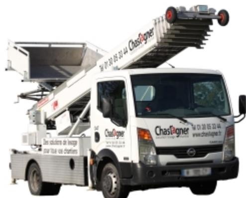
Monte-meubles sur véhicule Frosty 33 m avec opérateur. Ce monte-meubles autoporté est très utilisé lors des opérations de levage ou d'évacuation de tous types de matériaux depuis l'extérieur d'un bâtiment. Il permet un démarrage et un freinage progressif du chariot augmentant ainsi la sécurité. Deux treuils ainsi que des galets de guidage assurent la sécurité lors du déploiement des échelles.
