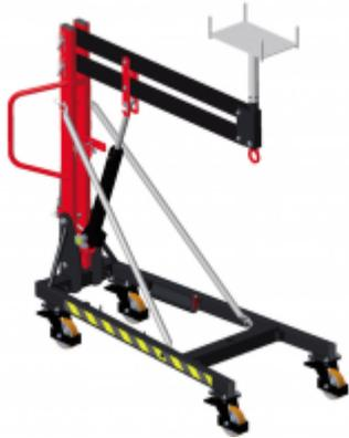
Lève-poutre hydraulique 600 kg / 3 m. Compact et démontable sur roues, cet élévateur est utilisé pour le levage et la mise en place de poutres. Repliable et facile à remonter sur chantier, il dispose d'une plateforme 360° pour le bon positionnement de la poutre.
