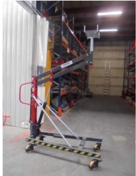
Lève-poutre hydraulique 600 kg / 3 m avec réhausse
