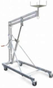
Lève-poutre 600 kg / 3 m. Compact et démontable sur roues, cet élévateur est utilisé pour le levage et la mise en place de poutres. Repliable et facile à remonter sur chantier, il dispose d'une plateforme 360° pour le bon positionnement de la poutre.
