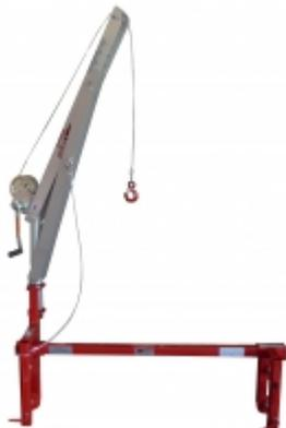
Grue de terrasse manuelle 400 kg. Ce matériel permet l'approvisionnement et l'évacuation des matériaux depuis une terrasse. Composé d'un treuil manuel, d'une potence et d'une pince d'acrotère, il permet une installation facile et ne nécessite aucun lestage.
