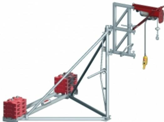
Grue de terrasse électrique 200 kg. Totalement démontable et assemblable rapidement sans moyens mécanisés, ce matériel permet l'approvisionnement de tous vos chantiers et l'évacuation des matériaux selon l'avancement des travaux. Grâce au principe des contrepoids, la grue ne nécessite aucun ancrage au sol.
