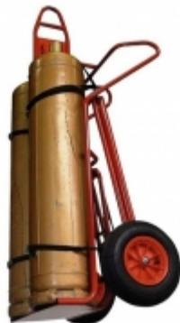
Diable élinguable pour deux bouteilles 250 kg. Ce matériel est utilisé pour la manutention sur chantier de bouteilles. Pouvant être converti en chariot incliné, ce diable est facile à manœuvrer grâce à sa béquille de maintien qui améliore les conditions de travail des opérateurs. Grâce à son système d'accroche en partie haute, ce diable est élinguable facilement.
