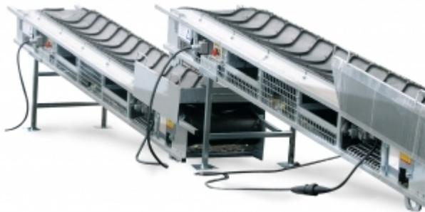
Convoyeur à bande 4,5 m. Monté en série, ce tapis de convoyage permet le transport de matériaux solides et non dangereux (sable, gravillon, terre, petit gravât, etc.) sur de grande distance. Grâce à un angle de montée pouvant atteindre 40°, ce transporteur peut accéder à des escaliers ou charger directement une benne à gravât. Équipé de trémies de chargement, il est également possible d'utiliser une mini-pelle pour le chargement.
